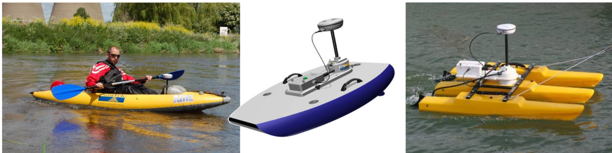
Abbildung 2: Verschiedene Schwimmkörper: Aufblasbares Kajak (links), Hydroboard (mitte), Trimaran (rechts). Beim Kajak wird der Sensor durch ein Loch im Boden gesteckt. Zu sehen ist in dem Bild nur die GPS Antenne (vor dem Paddel)
