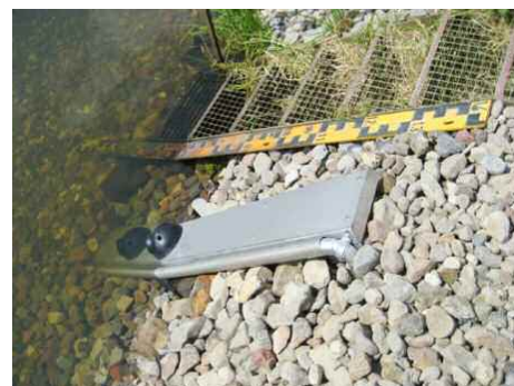
Zwei auf einem C-Profil montierte Wandler
